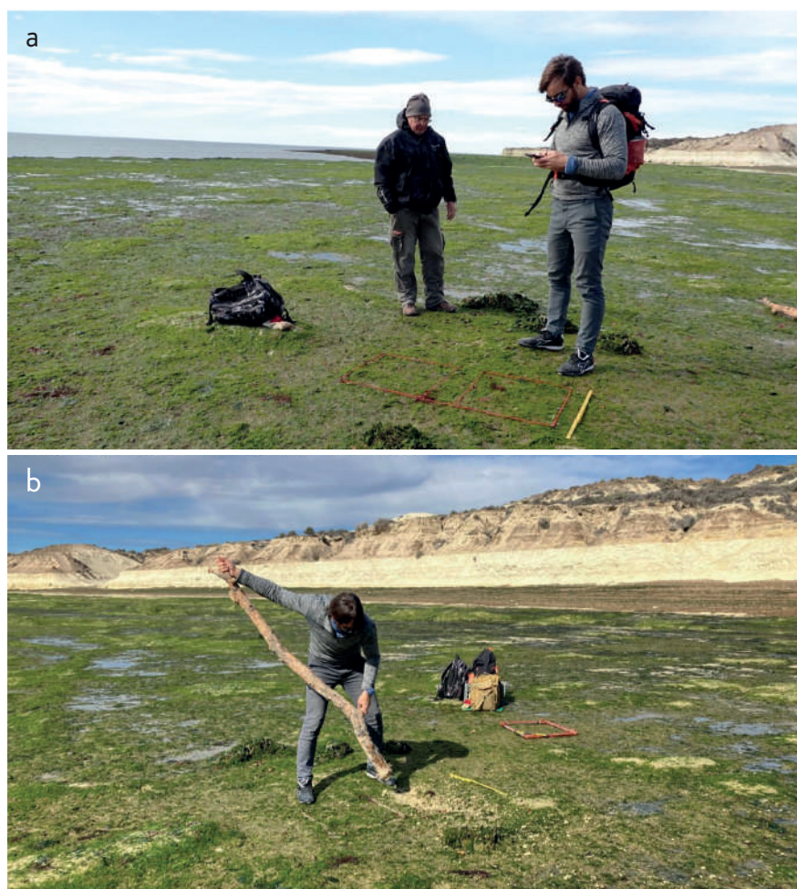
Figura 6: a) trazado de cuadrículas experimentales en la plataforma de abrasión de olas; b) operador desbastando la plataforma con un tronco de madera de aguaribay. Figure 6: a) layout of the experimental grids on the wave-cut platform; b) operator abrading the platform surface using an Aguaribay wooden trunk.
